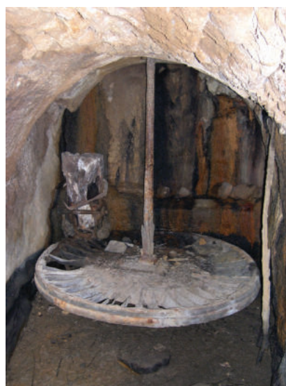
Ilustración 3: Poderosa fachada del molino de la Canal, en Huesa del Común, y su cárcavo y rodete. Fotos F. J. Lozano
